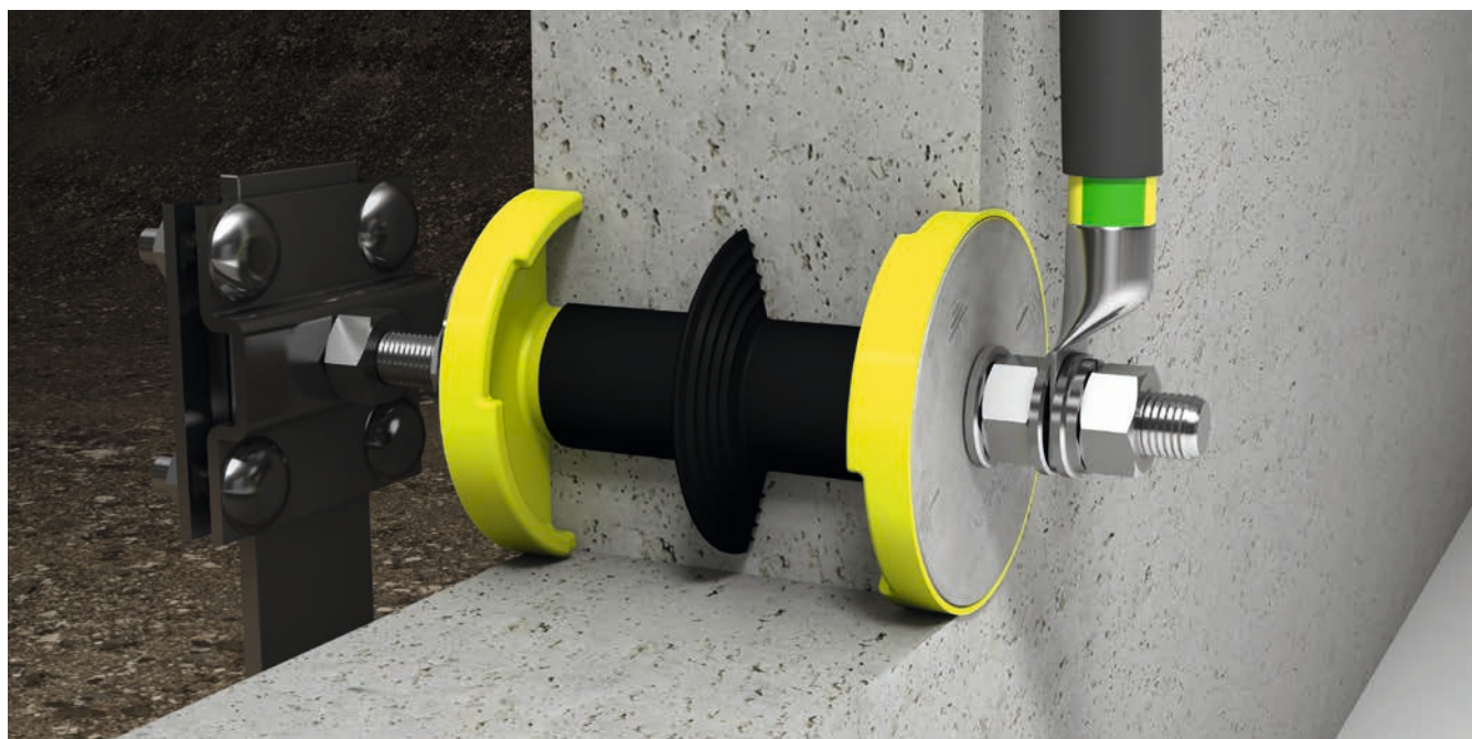
Passage de mise à la terre HEA-IS-M12: d'un côté, raccordement à barre d'acier plat par borne de fixation en croix Z-KG-M12 et de l'autre côté, raccordement d'un conducteur de terre par boulon de raccord Z-B-M12.
